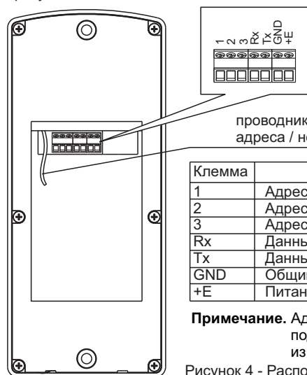
Рисунок 4 - Расположение и назначение клемм кнопочной панели
