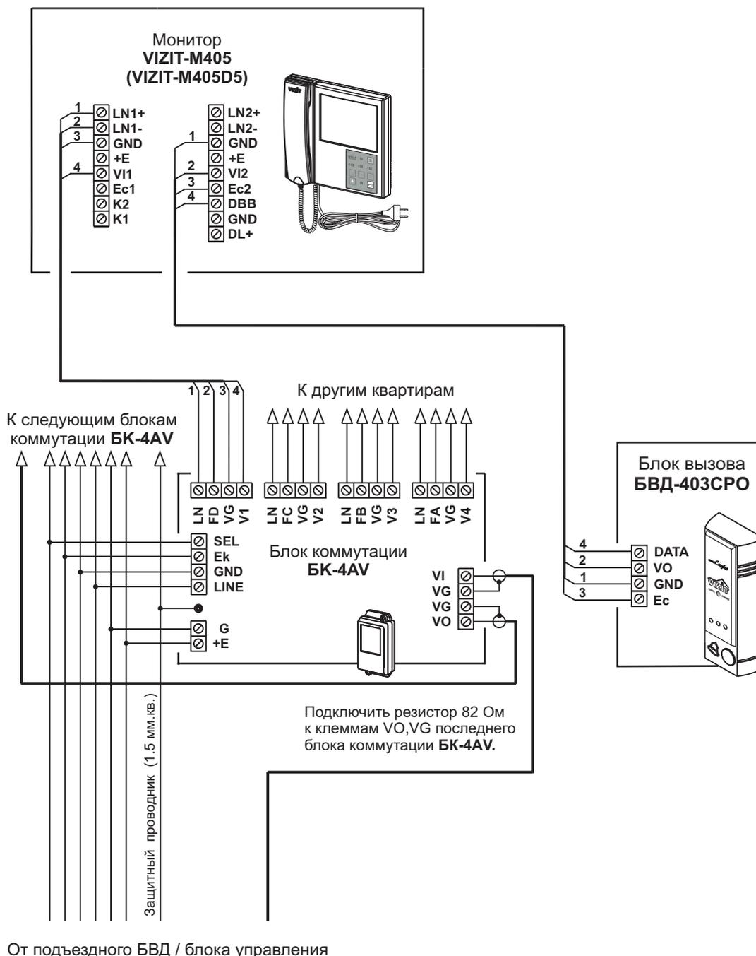
Рисунок 11 - Схема соединений монитора **VIZIT-M405 (VIZIT-M405D5)** с блоком коммутации **БК-4AV** и блоком вызова **БВД-403СРО** (телекамера + кнопка ЗВОНОК)
