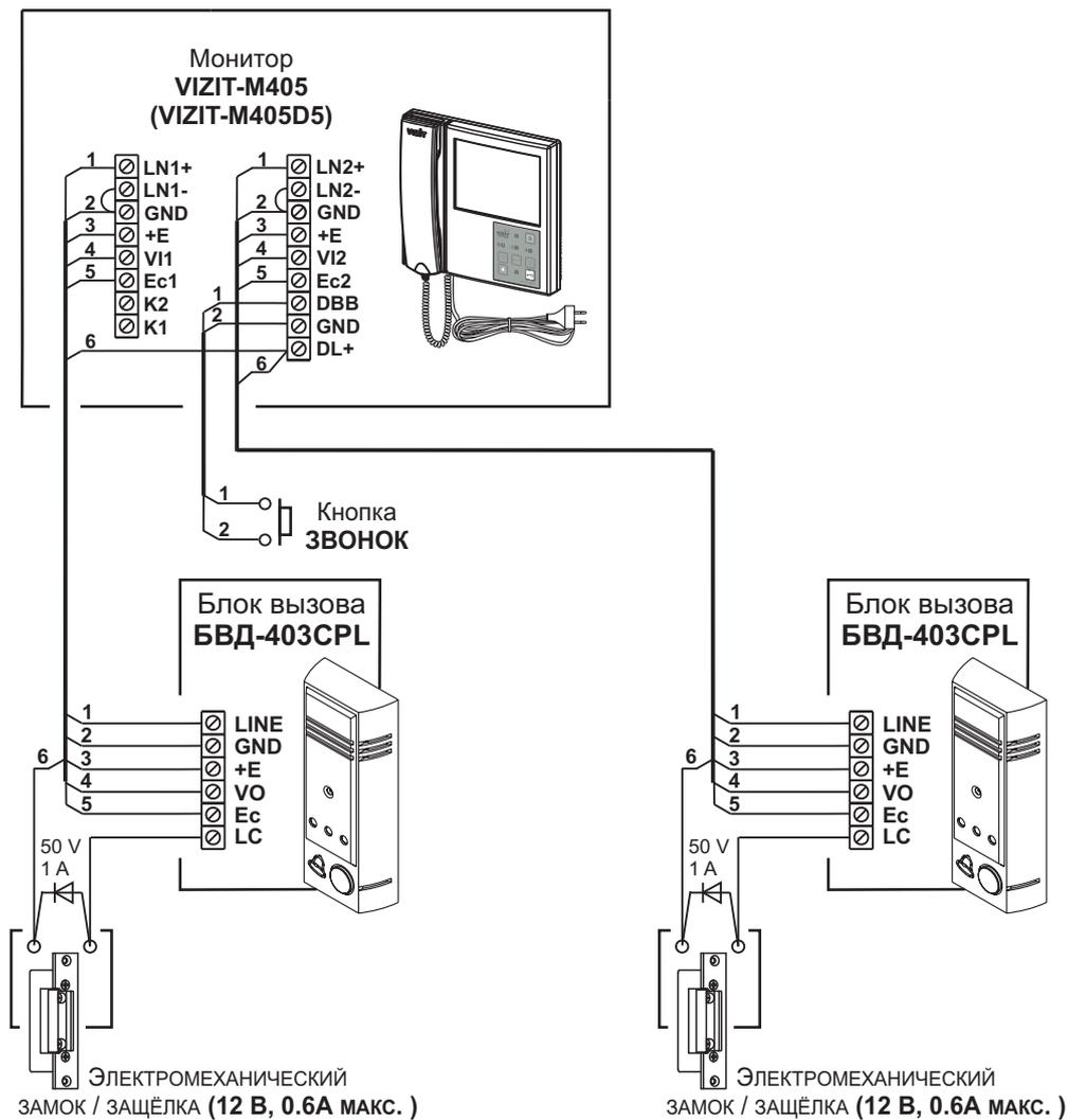
Рисунок 8 - Схема соединений монитора **VIZIT-M405 (VIZIT-M405D5)** с двумя малоабонентскими блоками вызова и кнопкой ЗВОНОК
