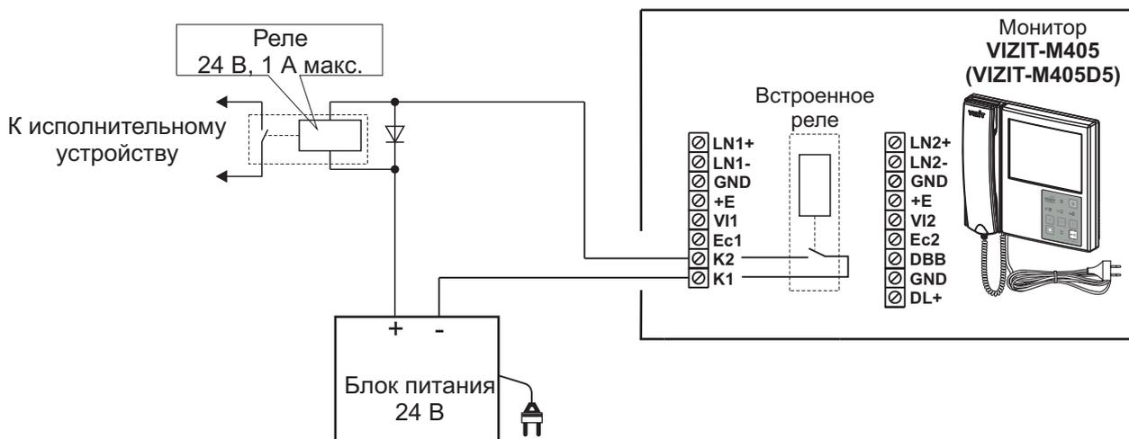
Рисунок 6 - Схема соединений промежуточного реле с питанием обмотки от внешнего блока питания.
