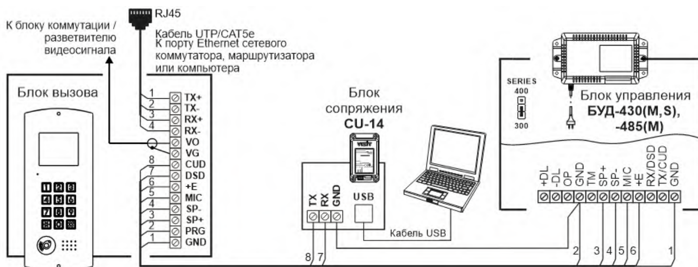
Рисунок 16.1 - Схема соединений блока вызова с блоками управления БУД-430(С, М), -480(С), -485(М) и блоком сопряжения CU-14
