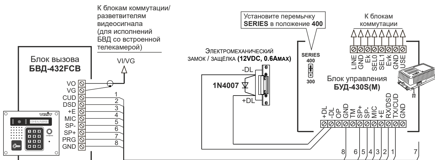
Схема соединений блока вызова БВД-432RCB с с блоком управления, электромагнитным замком VIZIT-ML400 и кнопкой "EXIT 500"
